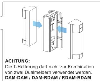
**ACHTUNG:** Die T-Halterung darf nicht zur Kombination von zwei Dualmeldern verwendet werden. **DAM-DAM / DAM-RDAM / RDAM-RDAM**
